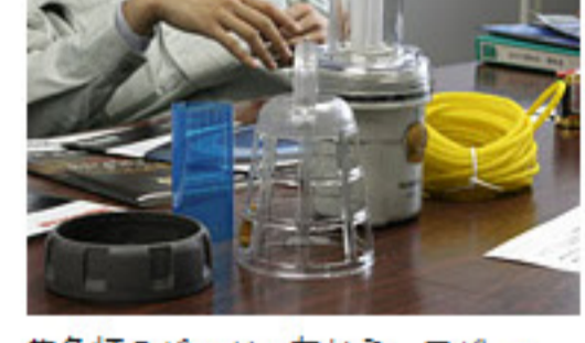
集魚灯のパーツ。左から、ラバー、ブルーフィルター、カバー、本体とグローブに覆われた蛍光管、付属品のロープ。
