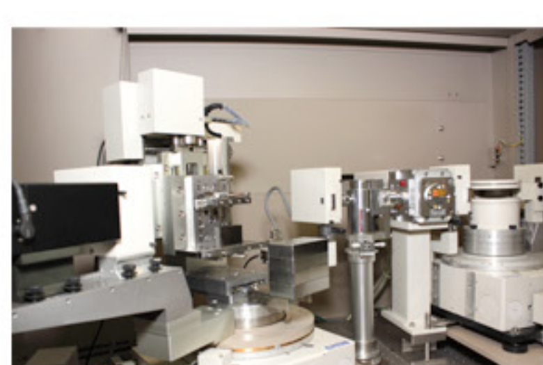
X線回折装置。指で示したあたりに、グラファイトのブロックが使われている。
