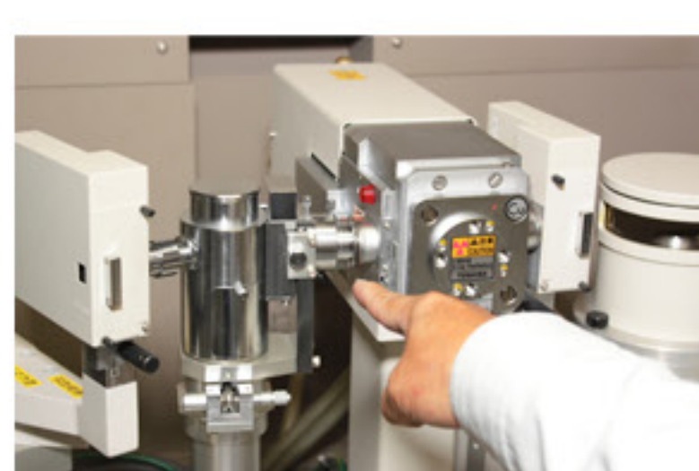
X線回折装置。指で示したあたりに、グラファイトのブロックが使われている。
