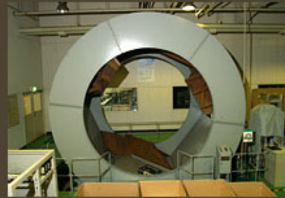
包装検査室の中でもひととき目についた巨大ドラム。振動や落下にどの程度耐え得るか、包装の強度を検証する。
