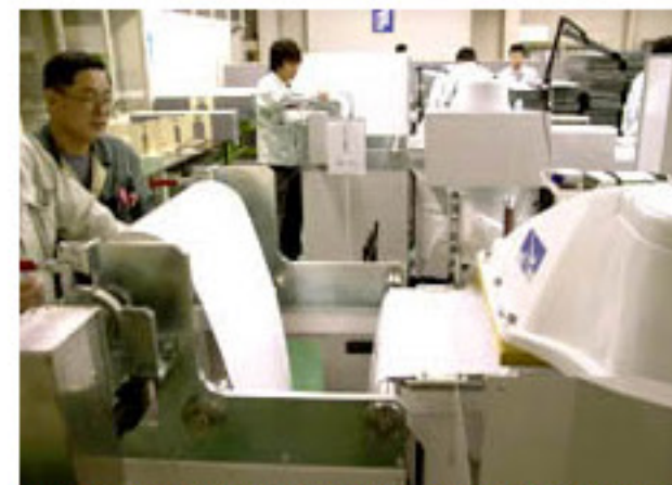
現在の製品ライン。紙のように見えるのが酸素富化膜。白く見えるのは、支持体の色である。
