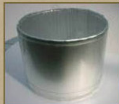
真空断熱材をジャーポット用に丸めたもの（この写真は最新の試作品）
