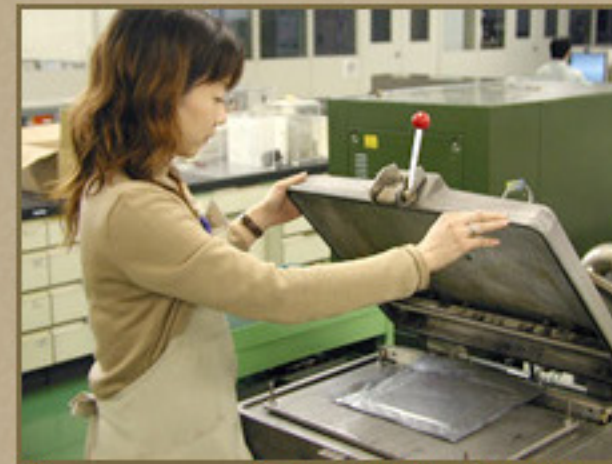
The ノンフロン冷蔵庫発売後も引き続き、芯材の加工法を変えては真空パックし、性能を測るといった作業は続いている。
