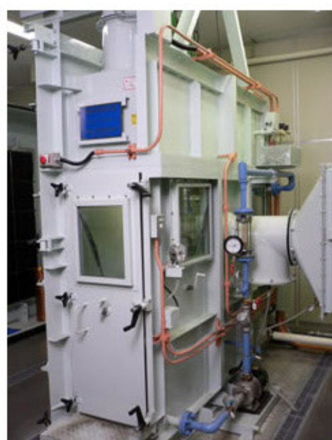
風雨実験を行う設備。換気扇を中央部分に設置して右側のノズルから水や風を浴びせる。
