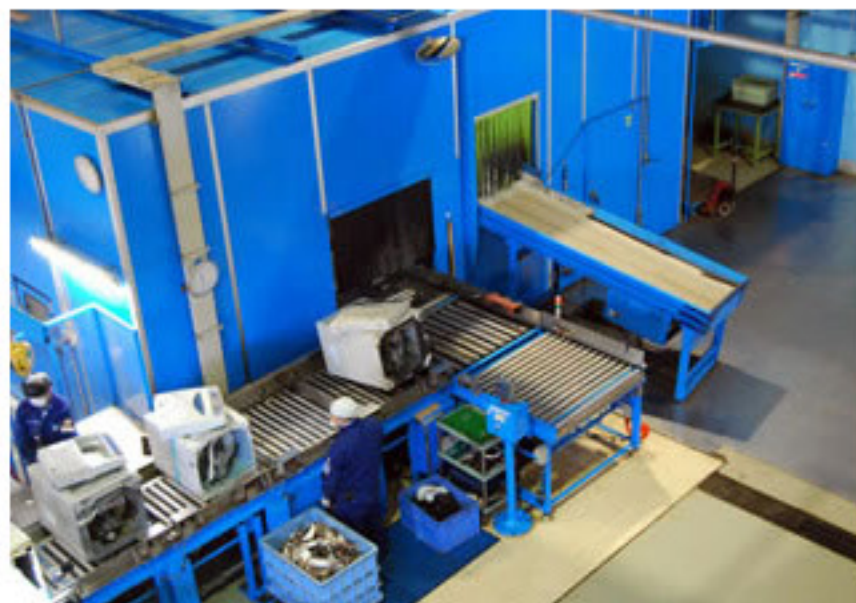
洗濯機が破砕機にまさに送り込まれようとしている。
