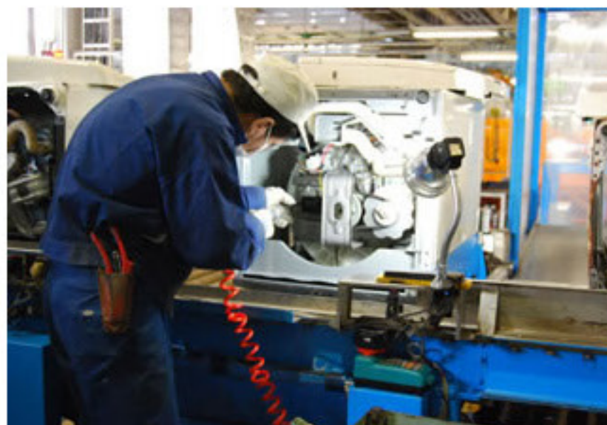
洗濯機からコンデンサーを取り出している。
