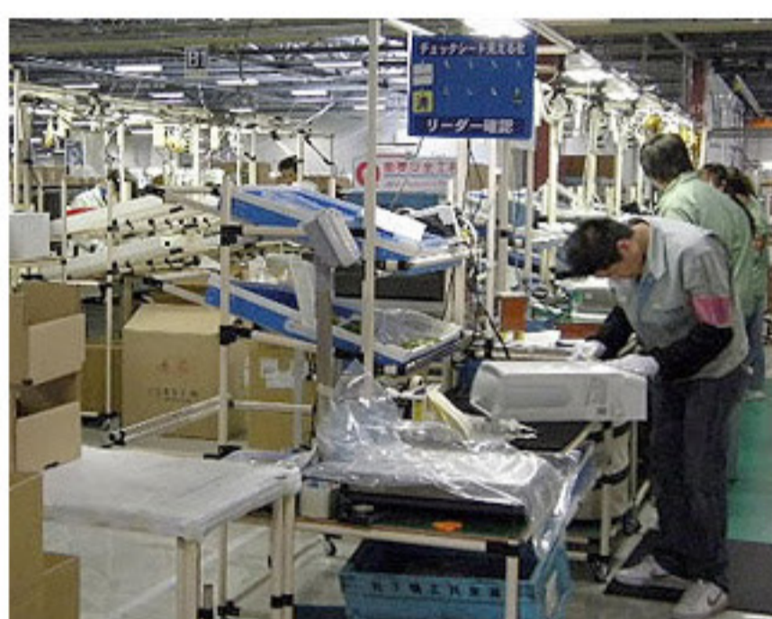
セル生産方式によって作業が行われている。
