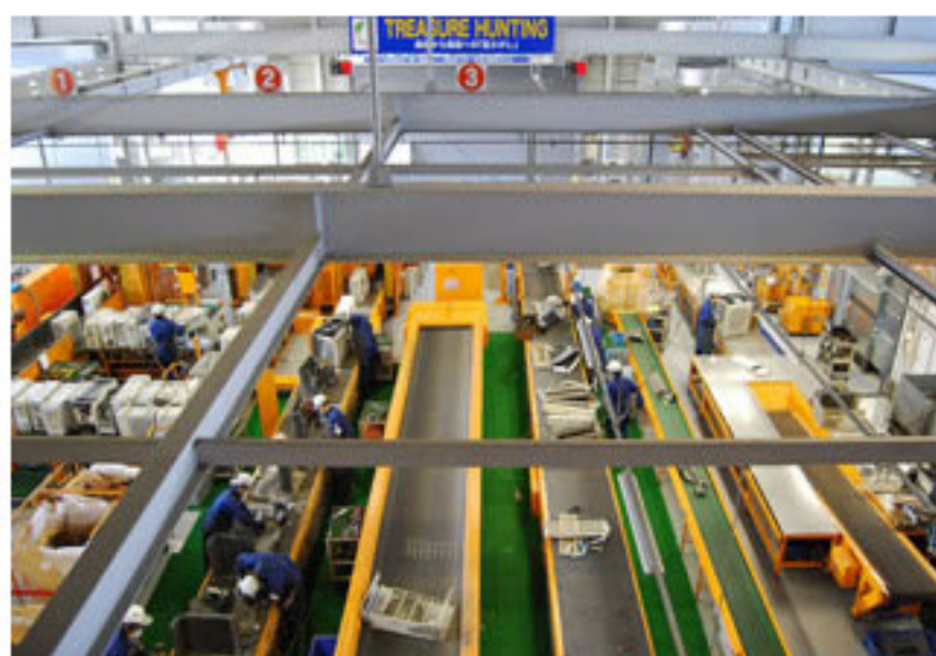
エアコンの室外機と室内機が別々に分解されていく。
