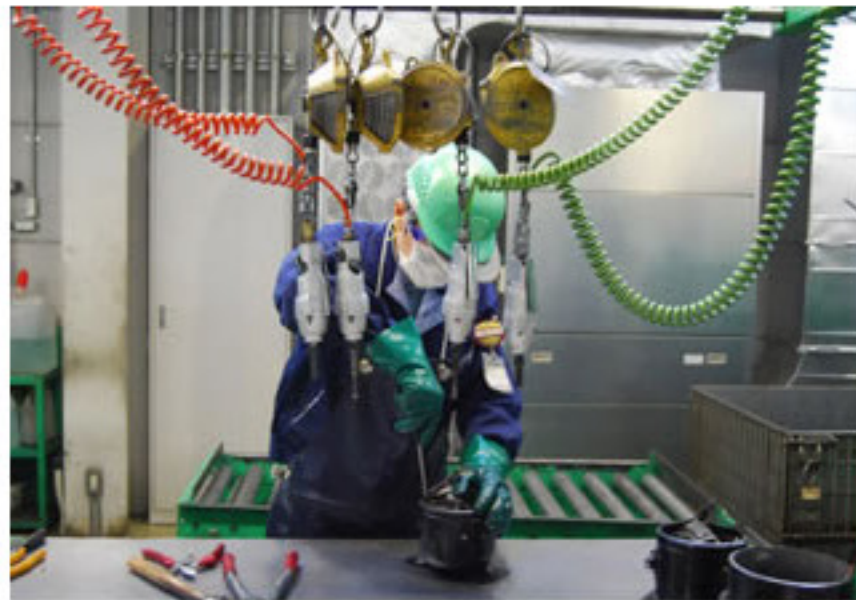
冷蔵庫のコンプレッサーを分解している。
