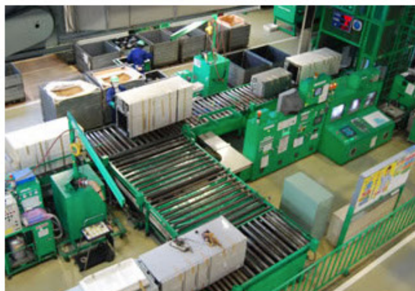
識別しにされた冷蔵庫が破砕機に流れていく。
