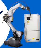
溶接ロボット
