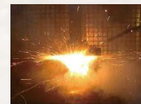
リオン電池の釘刺し試験
