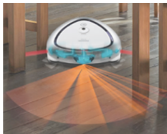
3種類の障害物検知（けんち）センサー搭載で、動きもスムーズ。
