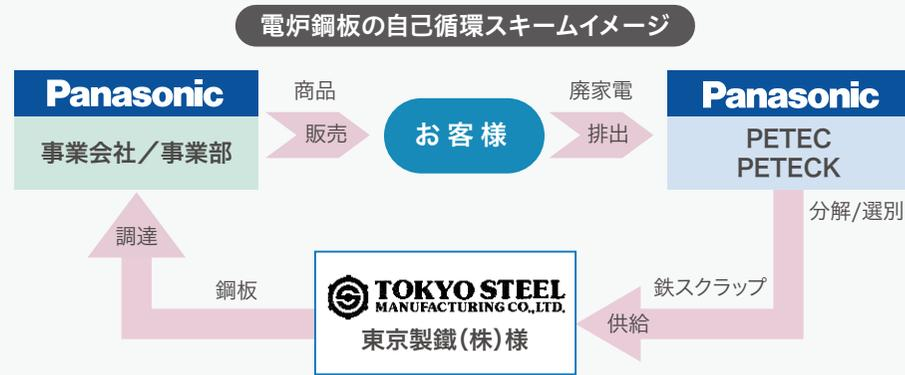
具体的には、PETECおよびパナソニック エコテクノロジー関東(株) (PETECK)で回収された家電製品由来の鉄スクラップを、東京製鐵(株)様に納入し、電炉鋼板<sup>※9</sup>に加工後、再び当社グループがそれを調達し製品に活用します。2010年から東京製鐵(株)様と検討を始め、再生鉄の品質を製品に使用できるレベルまで上げたり、加工性を向上させたりするための技術開発を行い、電炉鋼板特性に合った使い方を抽出し、さらに用途ごとに要求される特性(形状や強度、溶接性など)をチューニングして、2011年より電炉鋼板の薄板を製品へ導入してきました。そのような実績を経て2013年、当社グループ資本の家電リサイクル会社から納品された鉄スクラップを電炉鋼板に使用するスキームが実現しました。当初、当社グループからの鉄スクラップの提供は月50t程度でしたが、2023年度は1年間で2.5kt以上を東京製鐵(株)様に納品し、住宅用天井材や洗濯機など当社グループ関係会社製品に利用しています。
