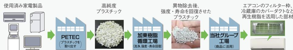
PETECでは、廃家電のシュレッダーダストから、用途や物性の異なる主要3種類の樹脂、ポリプロピレン(PP)、アクリロニトリルブタジエンスチレン(ABS)、ポリスチレン(PS)を、当社グループ独自の近赤外線識別技術などを用いて純度99%以上の高精度で選別します。
