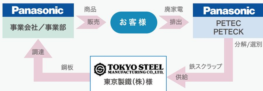
具体的には、PETECおよびパナソニック エコテクノロジー関東(株) (PETECK) で回収された家電製品由来の鉄スクラップを、東京製鐵(株)様に納入し、電炉鋼板<sup>※9</sup>に加工後、再び当社グループがそれを調達し製品に活用します。2010年から東京製鐵(株)様と検討を始め、再生鉄の品質を製品に使用できるレベルまで上げたり、加工性を向上させたりするための技術開発を行い、電炉鋼板特性に合った使い方を抽出し、さらに用途ごとに要求される特性(形状や強度、溶接性など)をチューニングして、2011年より電炉鋼板の薄板を製品へ導入してきました。そのような実績を経て2013年、当社グループ資本の家電リサイクル会社から納品された鉄スクラップを電炉鋼板に使用するスキームが実現しました。当初、当社グループからの鉄スクラップの提供は月50t程度でしたが、2023年度は1年間で2.5kt以上を東京製鐵(株)様に納品し、住宅用天井材や洗濯機など当社グループ関係会社製品に利用しています。
