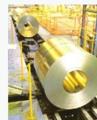
完成した電炉鋼板
