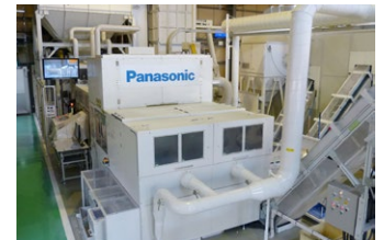
3種の樹脂を同時に選別できる近赤外線樹脂選別機
