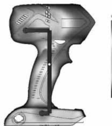
図7 充填時間の流動解析結果
