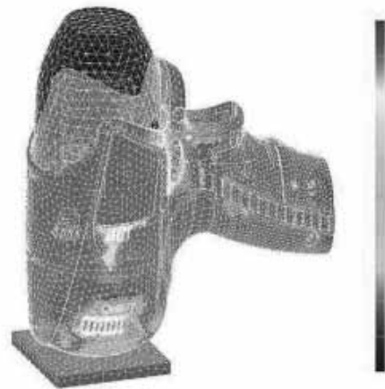
図 11 量産デザインの筐体による強度解析例
