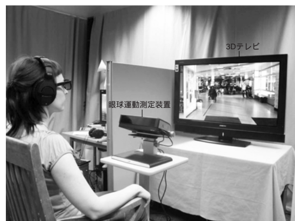
第3図 3D短編映画視聴中の眼球運動の測定風景
