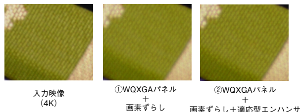
第9図 Pixel quadrupling技術による改善効果 Fig. 9 Improvement by pixel quadrupling technology
