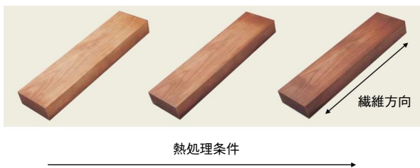
第2図 高圧水蒸気処理による着色 Fig. 2 Toning by high-pressure steam treatment
