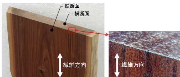
第6図 木材の繊維方向 Fig. 6 Fiber orientation of wood
