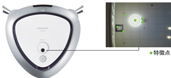
第2図 本体上面に向けてカメラを搭載したロボット掃除機とカメラが捉えた特徴点
