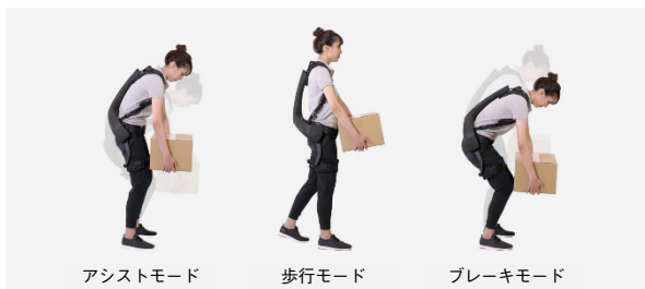
第2図 ATOUN MODEL Yの制御モード Fig. 2 Control mode of ATOUN MODEL Y
