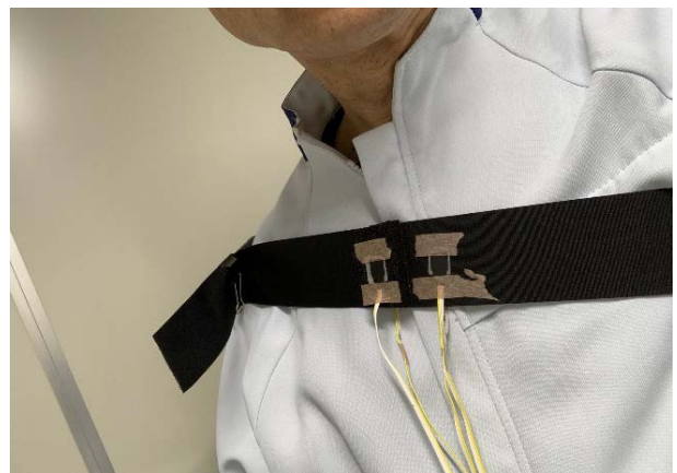
第5図 着衣量推定検証実験でのセンサ配置 Fig. 5 Measuring devices worn by the subject
